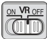
**ON** : Эффект дрожания фотокамеры уменьшается при нажатии спусковой кнопки затвора наполовину и в момент спуска затвора. Снижение уровня вибраций в видеискателе облегчает выполнение автоматической и ручной фокусировки, а также точного кадрирования объекта съемки.
