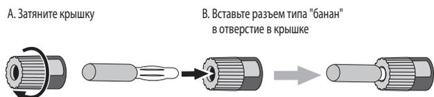
Всегда следует подключать цветной провод к клемме (+) на AVR и к клемме (+) на колонках (обычно положительный провод красного цвета) и цветной провод к клемме (-) на AVR к клемме (-) на колонках (обычно черного цвета).
