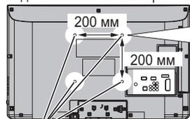
Отверстия для крепления [вид сбоку] настенного кронштейна
