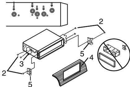
При установке по методу Б монтажный кожух и внешняя декоративная рамка не используются.
