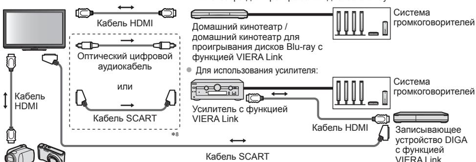
Видеокамера HD/фотокамера LUMIX с функцией VIERA Link
