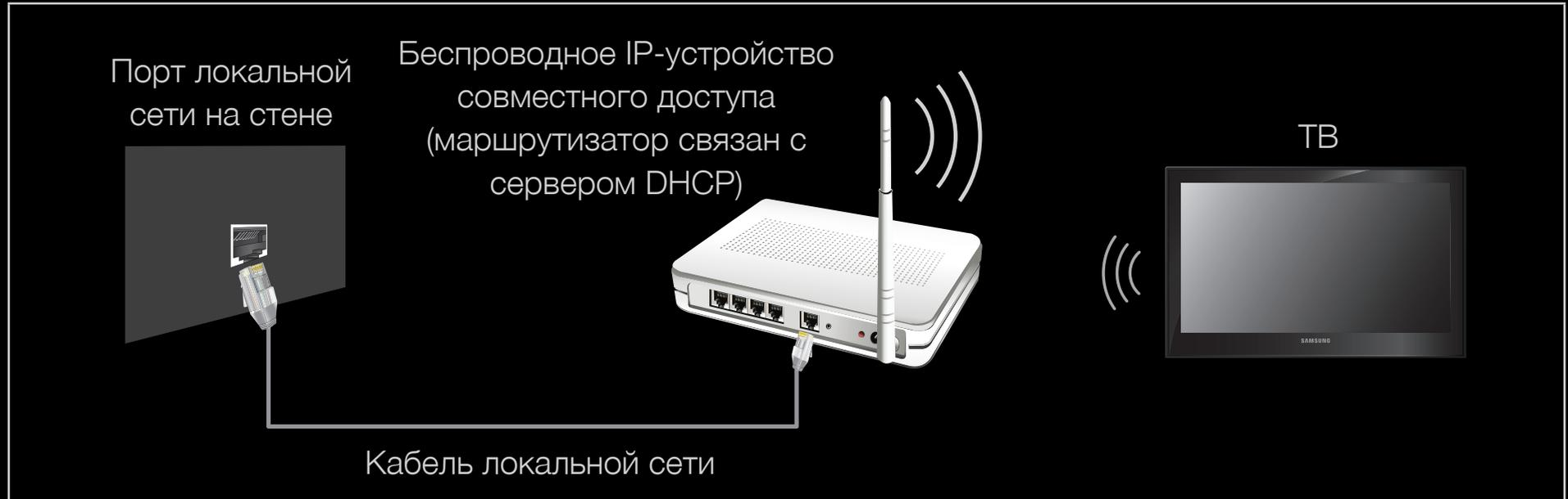
ТВ поддерживает протоколы связи IEEE 802,11a/b/g и n. Samsung рекомендует использовать протокол IEEE 802,11n. При воспроизведении видео через соединение IEEE 802,11b/g возможны перерывы.
