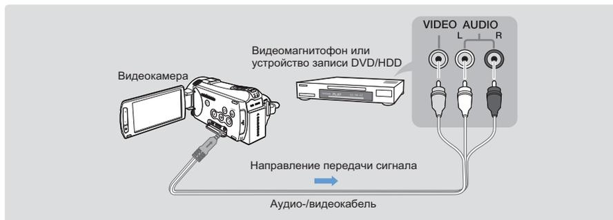
1. Подключите видеокамеру к устройству записи (видеомагнитофону или DVD/HDD) с помощью аудио-/видеокабеля.
