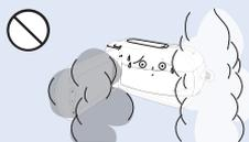
Не подвергайте видеокамеру воздействию сажи или пара. Густая сажа и плотный пар могут стать причиной повреждения видеокамеры или ее неправильной работы.
