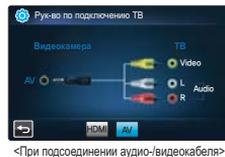
Подключите видеокамеру к обычному телевизору с помощью прилагаемого аудио-видеокабеля.
