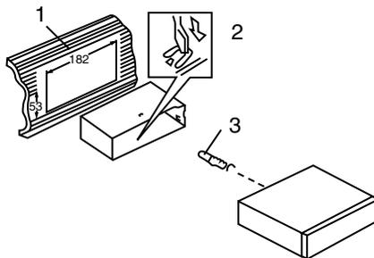
1. Установите монтажный кожух в приборную панель автомобиля, убедитесь, что он установлен правильной стороной и нет препятствий (провода, элементы приборной панели) для установки магнитолы.
