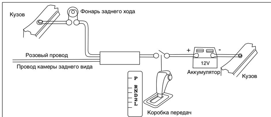
Если подключена камера заднего вида, при движении автомобиля задним ходом устройство автоматически переключится на изображение с камеры заднего вида. При окончании движения задним ходом устройство вернется в исходный режим.
