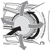
Поворачивать для регулировки громкости/выбора параметра меню.
