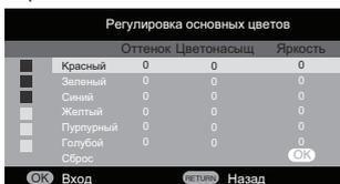
**3** Нажмите кнопку **▶**, затем с помощью кнопок **◀** и **▶** выберите **Оттенок**, **Цветонасыщ.** или **Яркость**.
