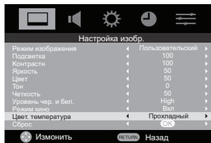
С помощью кнопок **◀** и **▶** выберите значение параметра **Цвет. температура** (Умеренный, Теплый, Холодный).
