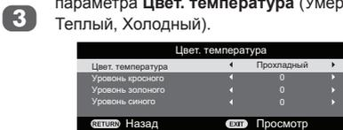
**4** С помощью кнопок **▲** и **▼** выберите параметр, который необходимо настроить, а с помощью кнопок **◀** и **▶** выполните настройки.
