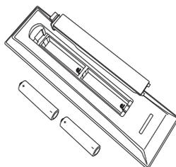
Снимите крышку батарейного отсека на задней панели пульта ДУ и установите батареи, соблюдая правильную полярность.
